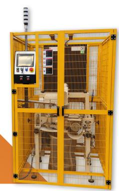
Efetua a retificação dos topos das rolhas de cortiça dando-lhes a forma de boleado. Esta é também a máquina que fabrica as esferas de cortiça para a Tequila.
