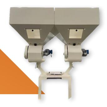
Sistema de alimentação automático para todo o tipo de rolhas adequado para alimentar máquinas de retificação de corpos.
